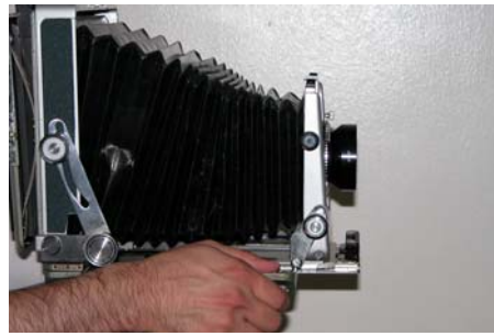
٦ - ضبط العدسة ( الفوكس ) عن طريق تحريك المنفاخ
