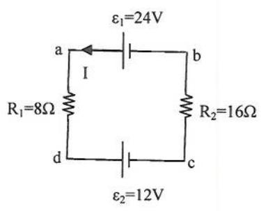
(7) باستخدام المعلومات المعطاة في الشكل المجاور، احسب التيار في الدائرة I
