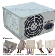
مصدر الطاقة (Power Supply)
