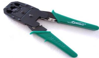
وهي مشابه لأداه تستخدم لتوصيلات الهاتف و قد تجد أداة تستخدم للنوعين من التوصيلات. وقد تحوي قطاعه أسلاك أيضاً أو سلاخة غلاف الأسلاك. وتستخدم في كبس ( ضغط ) أسلاك **CAT-5** داخل توصيلة **RJ45**.
